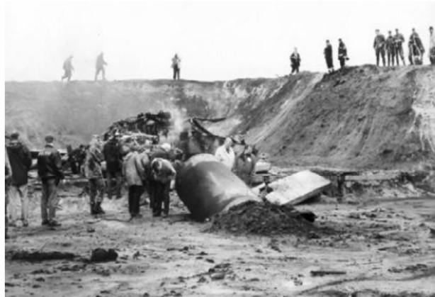
Ensayo de explosión de un tanque de propano junto a un embalaje tipo CASTOR. El embalaje sufrió un vuelco y se incrustó en el terreno (imagen de la derecha) sin llegar a sufrir daños mecánicos de importancia ni pérdida de estanqueidad (Lange y otros, 2003).
