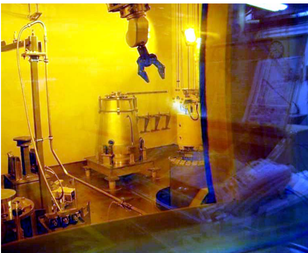
CELDA DE DESCARGA DE LOS RESIDUOS DE ALTA ACTIVIDAD Y ELEMENTOS COMBUSTIBLES
