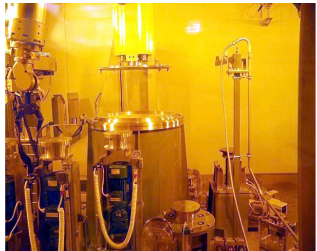
CELDA DE DESCARGA DE LOS RESIDUOS DE ALTA ACTIVIDAD Y ELEMENTOS COMBUSTIBLES
