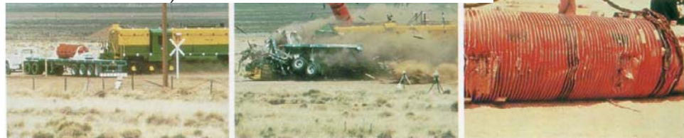
Ensayo de choque de una locomotora contra un transporte a 131 km/h (Sandia Nacional Laboratorios, EE.UU.).
